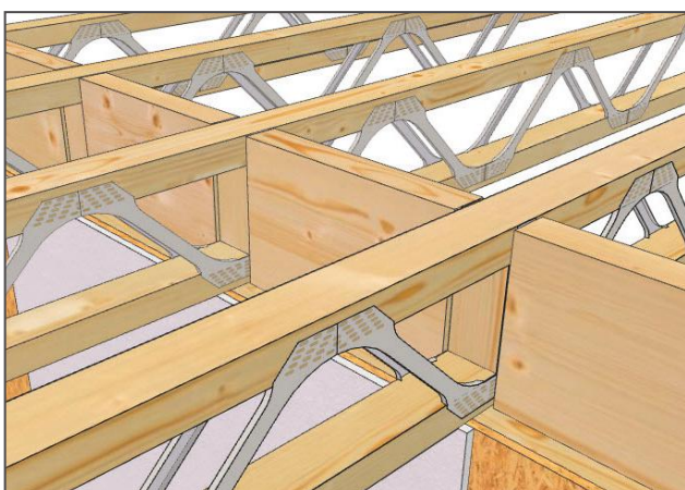
Obr. 7. Ztužení podlahových nosníků pomocí vložené fošny
