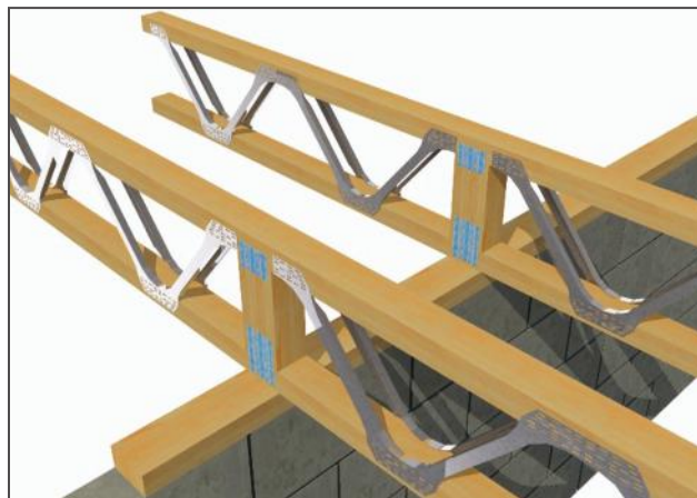
Obr. 6. Detail uložení na vnitřní nosnou stěnu
