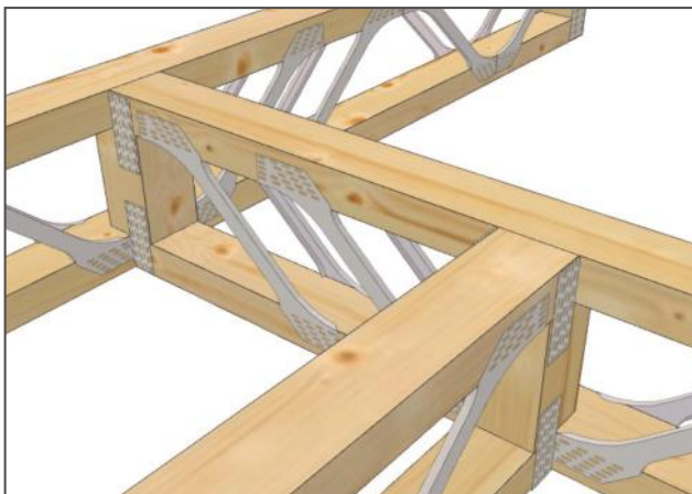
Obr. 5. Vytvoření podlahové výměny pomocí nosníku Posi
